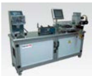
Brabender® 16mm basic line de doble tornillo extrusor ofrece los requisitos técnicos para desarrollo básico de formulación escala laboratorio en un espacio reducido. El sistema combina adaptabilidad de las longitudes de procesamiento con limpieza fácil y manipulación a través del barril de concha de almeja segmentado
